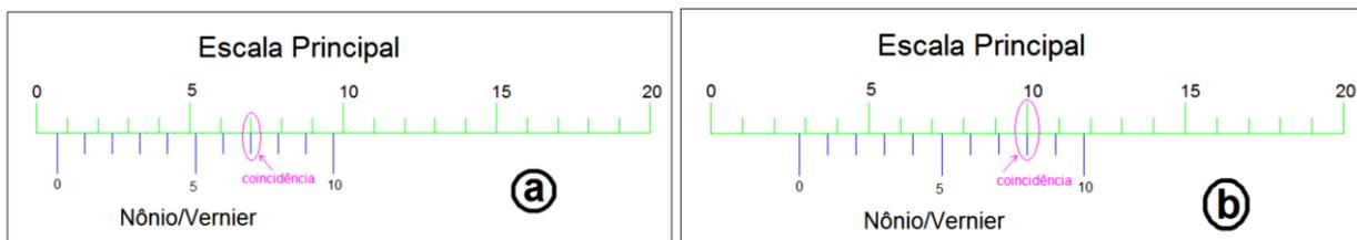
Figura 2. Exemplos de leitura com um Nônio de  $N = 10$  divisões. Na figura 2, o Nônio se deslocou uma fração da 1ª divisão da escala principal e essa fração foi de  $7/10$ . Já na figura 2b, o deslocamento do Vernier foi 2 divisões da escala principal e uma fração cuja leitura no Nônio foi de  $8/10$ , ou seja, a leitura final é de 2,8 divisões da escala principal.
