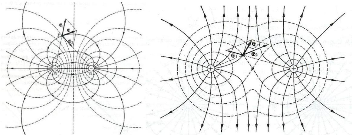
FIGURA1. Linhas de força (contínuas) e superfícies equipotenciais (pontilhadas) do campo elétrico de duas cargas iguais, mas de sinais contrários e de mesmo sinais.
