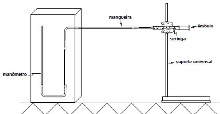
Figura 2. Representação esquemática do aparelho utilizado para verificação experimental da lei de Boyle – manômetro aberto.
