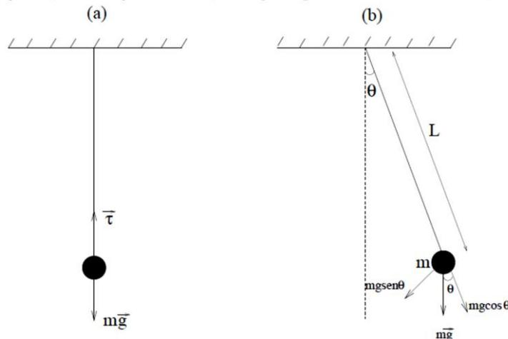
Figura 1: (a) Pêndulo simples em repouso. (b) Pêndulo simples em pequenas oscilações.
