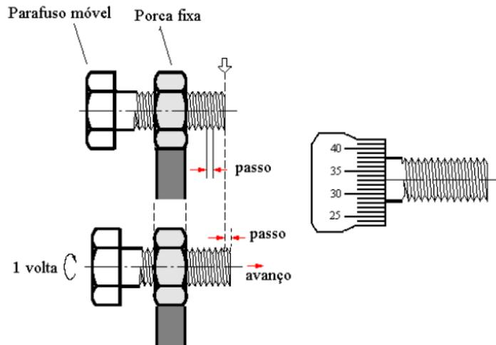
Figura 2 – Esquema de um sistema formado por um parafuso móvel e uma porca fixa.
