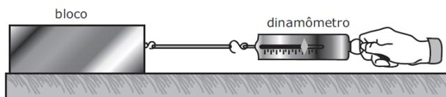
ii. Com o corpo de prova sobre a tabua, mantendo o dinamômetro paralelo a superfície, aplique uma força sobre o corpo, de forma que ele ainda permaneça em repouso e vá aumentando a força aplicada lentamente até que o corpo de prova entre em movimento. Registre na tabela abaixo.
