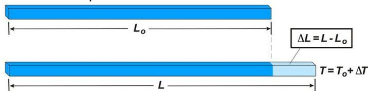
Figura: A figura representa a dilatação linear de uma barra metálica.
