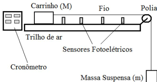
Figura 1- Esquema da montagem experimental do trilho de ar.
