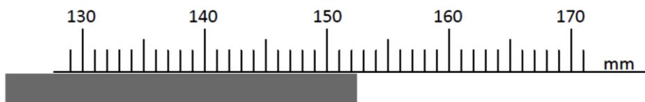
FIGURA 3. Régua milimetrada usada para medir o comprimento de uma barra de madeira.
