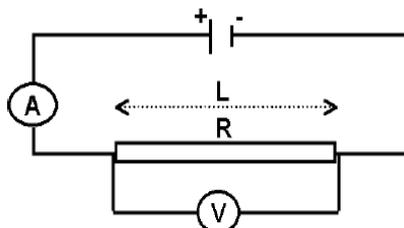
ii. Medir o diâmetro do fio com auxílio do paquímetro e calcular a área de seção transversal do condutor.
