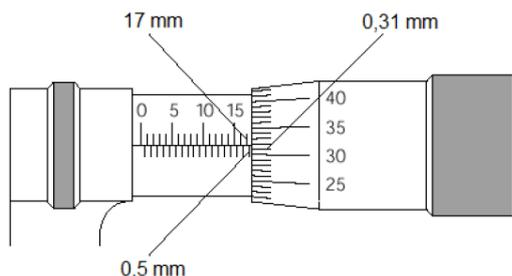
Figura 3 – Exemplo de leitura em um micrômetro.
