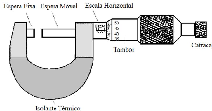
Figura 1 – Esquema de um micrômetro mostrando as principais nomenclaturas.
